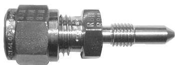
Gyrolok校正機器用継手は、差圧伝送器を校正するために必要な時間を減らすことにより、時間と経費を節約します。ボディは316ステンレス製で片側が1/4インチのGyrolokポート、もう一方のエンドは平行ねじとなっており、円錐形の金属面同士でシールします。この設計により技術者が機器を分解せずに容易に伝送機を調整する事が可能です。尚、本体の組付けにシールテープを使う必要はありません。Gyrolokのフェール動作制御によりコストパフォーマンスと耐久性を向上させています。
