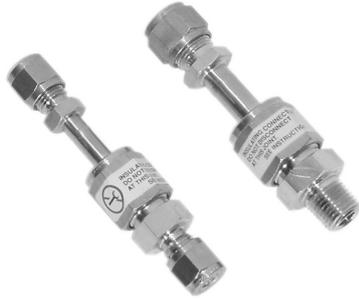
Gyrolok絶縁継手はパイプまたはチューブを流れている電気を遮断します。この継手は計測機器など電気を取り除く必要があるアプリケーションのために使われます。
