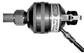
Gyrolokナットとフェルールを、液圧プリセッティングツールへと組付け、インジケータアームが解放されるまで手でハンドポンプを上下させます。
